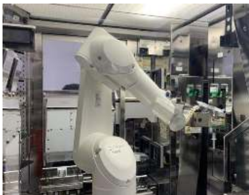
Automate RIVA qui fabrique des chimiothérapies injectables. L'établissement de santé est le premier en Europe à en être équipé.
